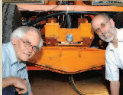
Foto bo en middel: Die 20-ton verkeersnabootser wat versnelde toetse op padoppervlaktes kan doen.
